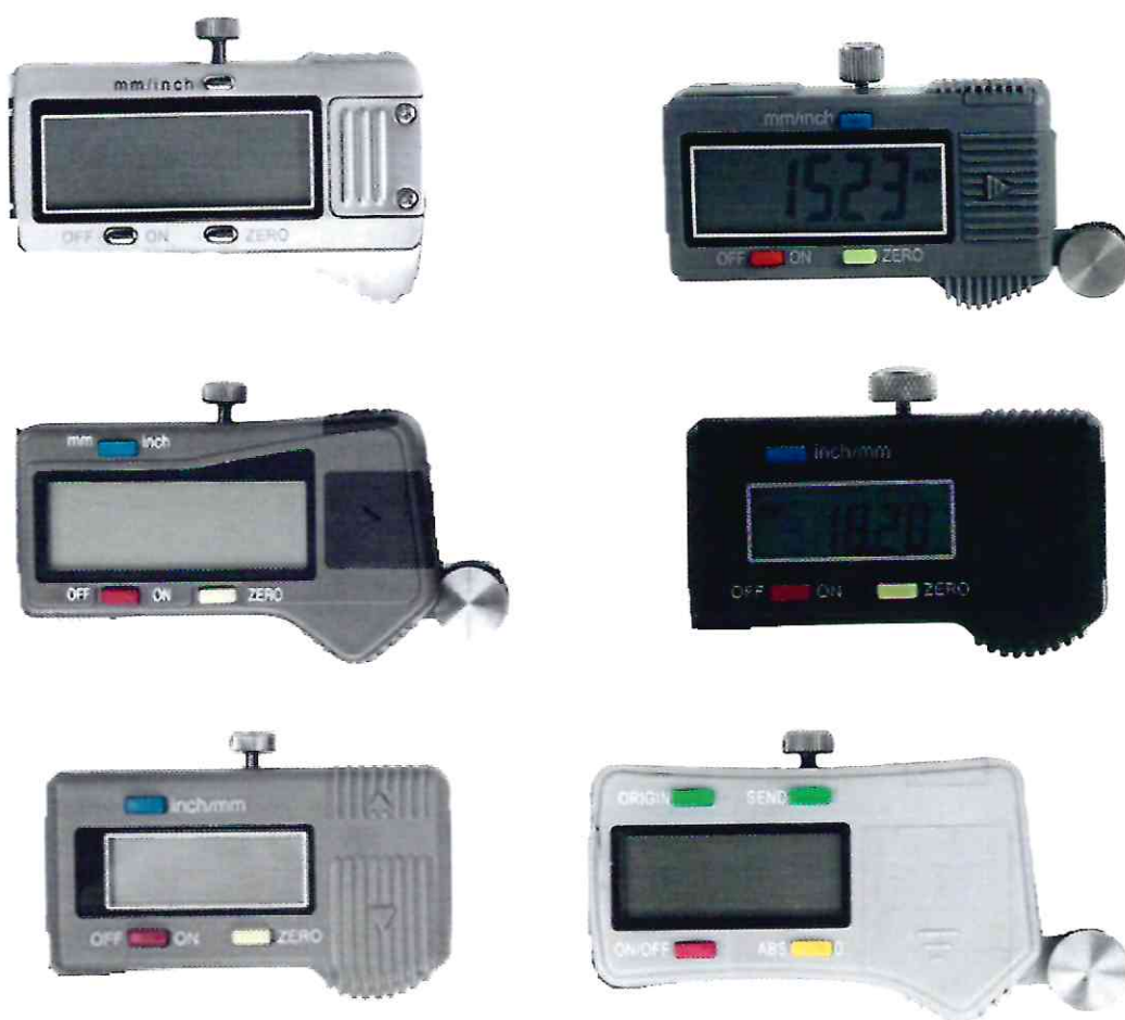
Рисунок 8 – Внешний вид корпуса цифрового отсчетного устройства
